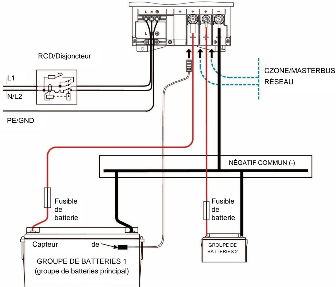
Figure 3 : Schéma d'installation du ChargeMaster Plus
