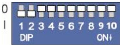
Figure 4 : Commutateurs DIP (Réglages usine)
