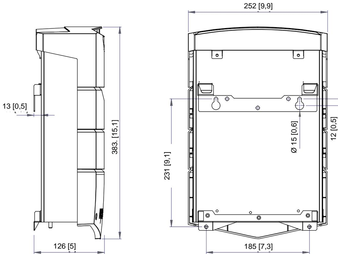
Dimensions, mm [po] ChargeMaster Plus modèles 24/80-2, 24/110-2.
