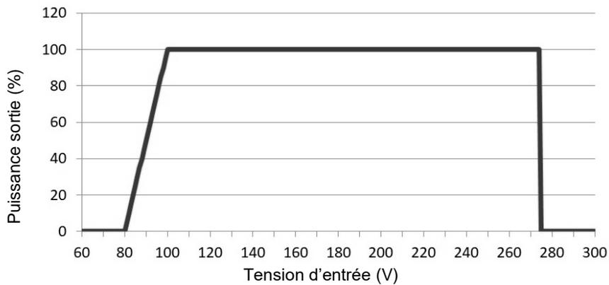
Figure 8 : Puissance sortie versus tension d'entrée
