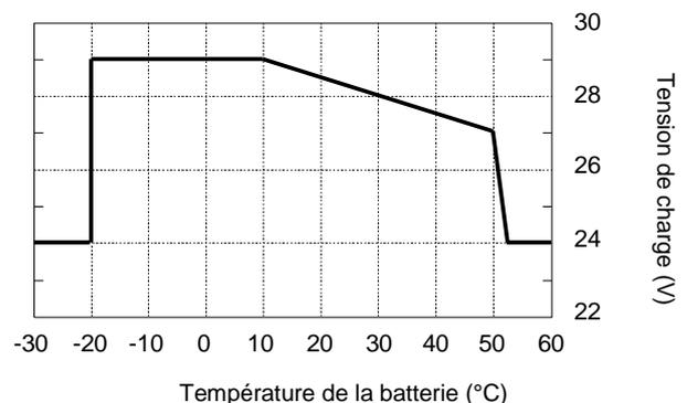
Figure 7 : Charge avec compensation de température
