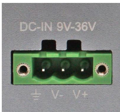
Le connecteur mâle correspondant est livré avec 60 cm de câble négatif et positif. Le câble noir doit être raccordé au négatif et le câble rouge au positif.
